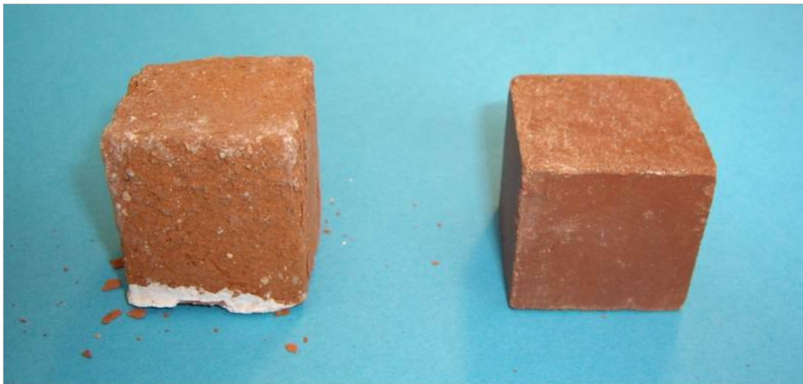
Laboratorijski modeli cigle nakon 6-mesečnog izlaganja vlazi: etalon i konzerviran uzorak
