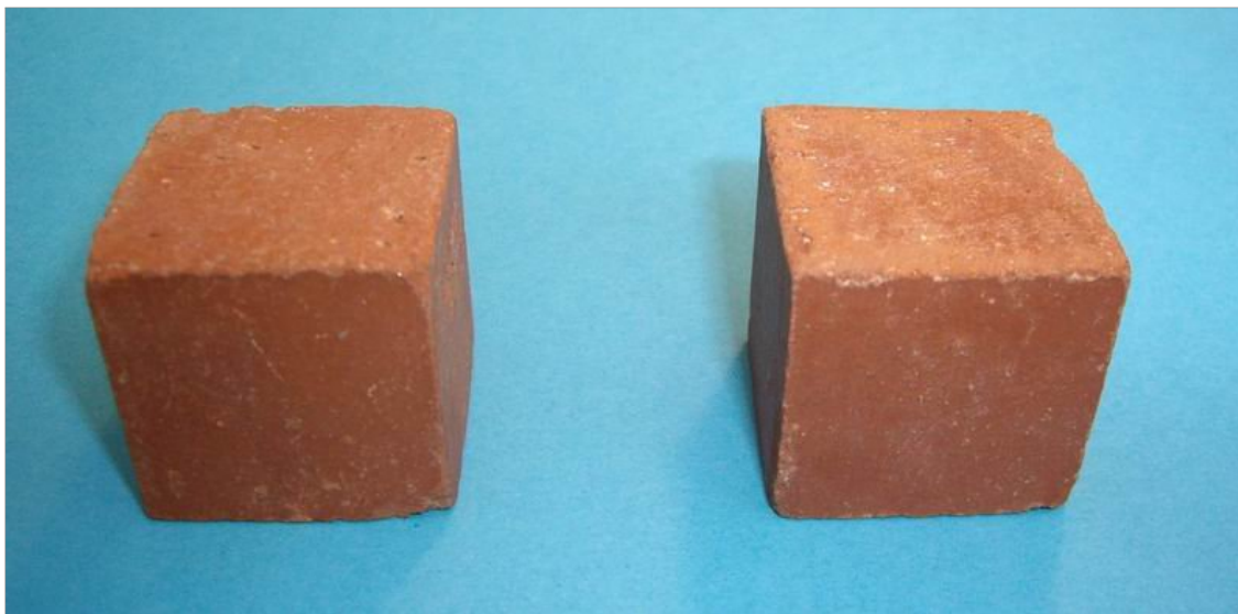
Laboratorijski modeli cigle: etalon i konzerviran uzorak
