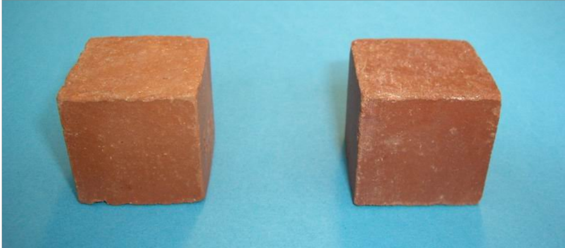
Laboratorijski modeli cigle: etalon i konzerviran uzorak
