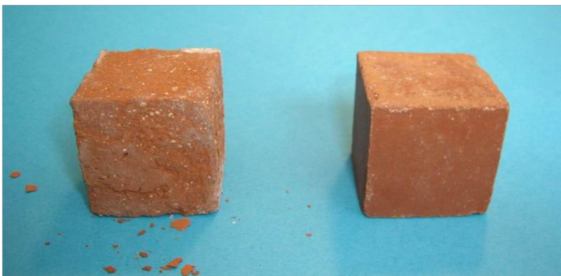
Laboratorijski modeli cigle nakon 30 ciklusa smrzavanje-odmrzavanje: etalon i konzerviran uzorak
